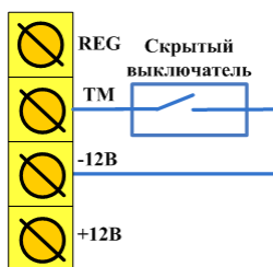
Рис. 7.2. Схема подключения скрытого выключателя
