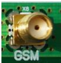
Рис. 4.3. SMA-разъем для подключения GSM-антенны
